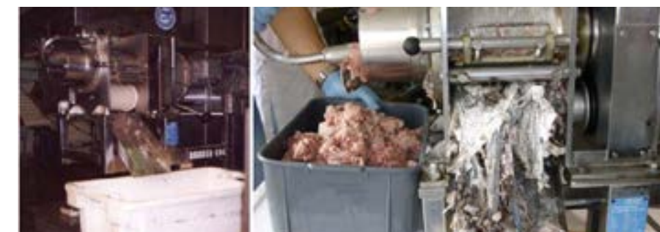
Figura 2. Separador mecânico e separação da polpa da pele e espinhas
